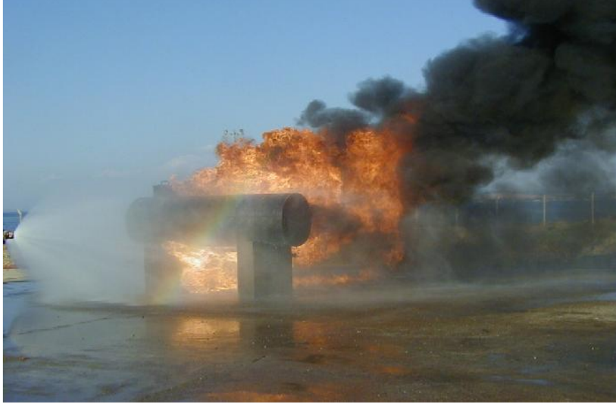
Resim 1. Su ile tankın her yüzeyinde soğutma yapılarak tankın yarılması ve patlaması önlenir.
